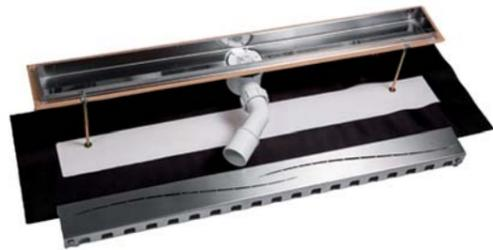
Voll-Edelstahl Duschrinne 50 bis 150cm mit herausnehmbarer massiver Blende, hergestellt aus ThyssenKrupp Edelstahl. Inkl Siphon mit Auffangbehälter und integrierter Geruchssperre Wassersperrhöhe 25mm, Ablaufleistung bis zu 45l./min. Ablaufbogen 45° mit 40/50mm Abgang
